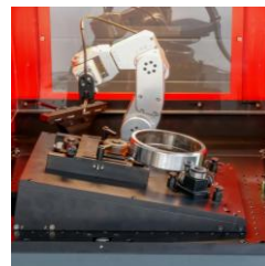
Detectarea fisurilor pe inele cu eddyrobot
