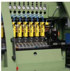
Detectarea fisurilor integrată în mașina de superfinisare pe role
