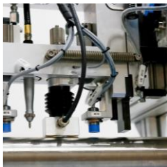
Detectarea fisurilor la produsele semifabricate
