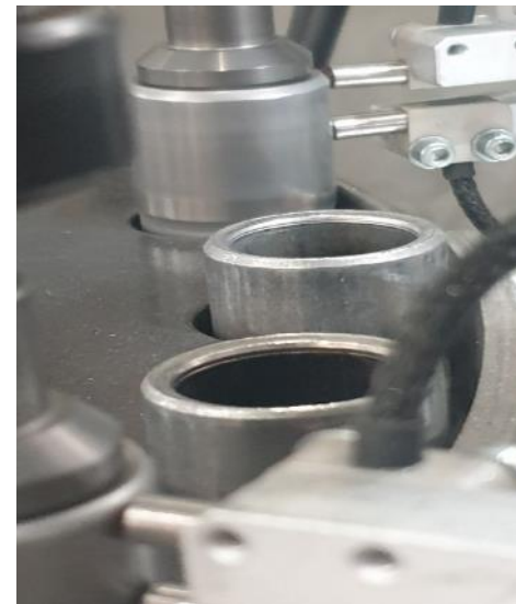
Testarea suprafeței complete pentru fisuri la viteză mare
