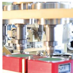
Detectarea fisurilor și testarea structurii la came și a arborilor cu came
